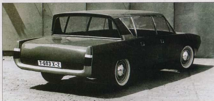
Laminátová maketa projektu X-2 v „životní“ velikosti, pozornost si zaslouží negativní sklon zadního okna.
