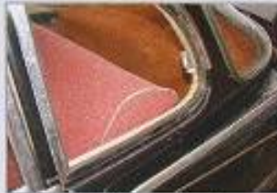
Dreiecks-Fenster: Rund um das Ausstellfenster droht Korrosion
