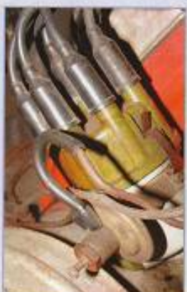
Verteiler: Er ist robust, Kontakte sind Standardware
