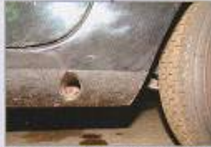
Volles Rohr: Schmutzwasser zerstört die Wagenheberaufnahmen...
