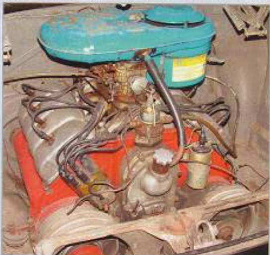
Vergaser: Bei undichten Flanschen droht Abmagerung
