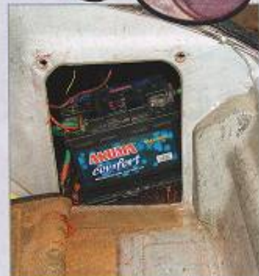
Batterieverlisse in den vorderen Kotflügeln: Tatort gefürchteter Säureattentate
