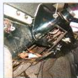
Komplex: Das Schaltgestänge ist meistens ausgenudelt
