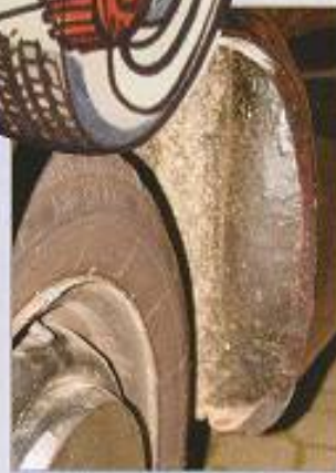
Auch im Osten nichts Neues: Korrosion in den Radkästen vorn
