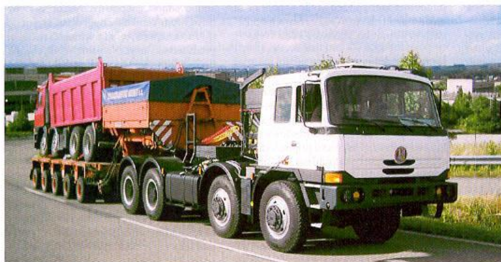
Čtyřnápravový tahač HETT je schopen manipulovat se soupravou o CELKOVÉ HMOTNOSTI AŽ 116 t . A to nejen na silnici, ale také v terénu!
