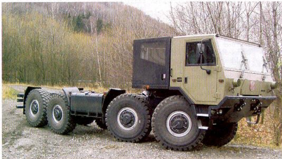
Čtyřnápravový podvozek projektu JAR je vybaven nízkou budkou. Motor a jeho systémy jsou umístěny za budkou – její podlaha je tedy plochá!
