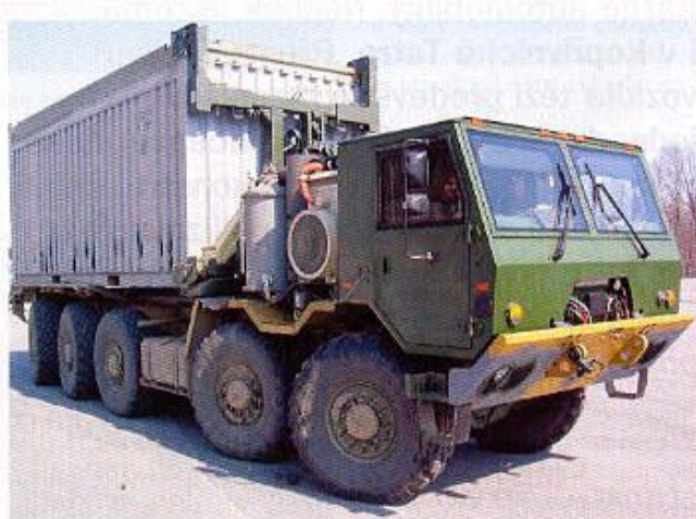
▲ Projekt LVSR pracuje s PĚTINÁPRAVOVÝM podvozkem tatrovácké koncepce
