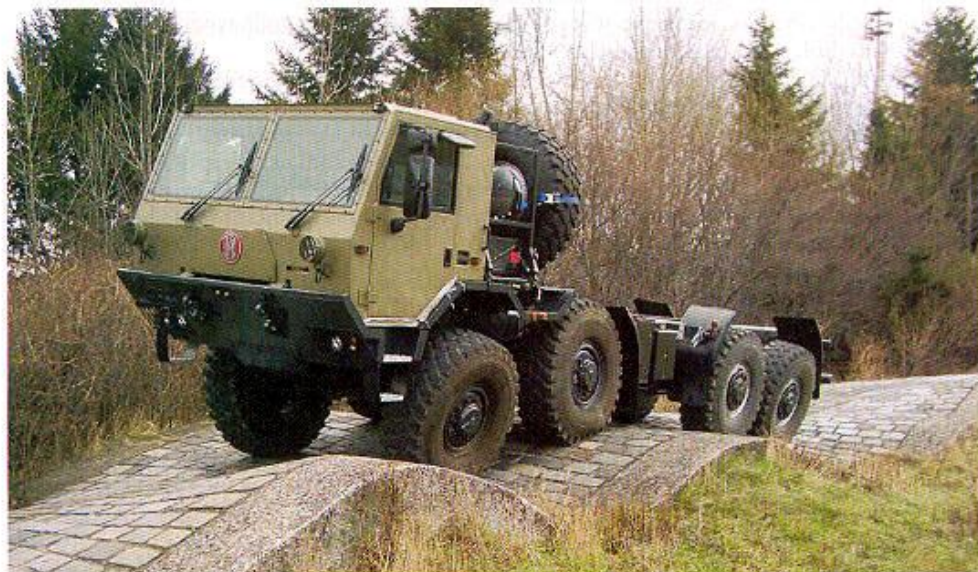
Prototyp podvozku 8x8 nové obchodní řady T815-7 s nízkou kabinou. Konstrukce kabiny odpovídá možnosti přepravy vozidla vojenským letounem C-130 HERCULES
