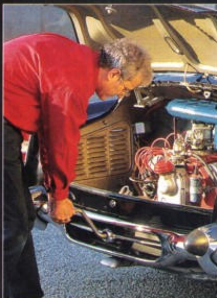
Batterie platt? Kein Problem, die Anlasserkurbel gehörte noch 1960 zur Grundausstattung
